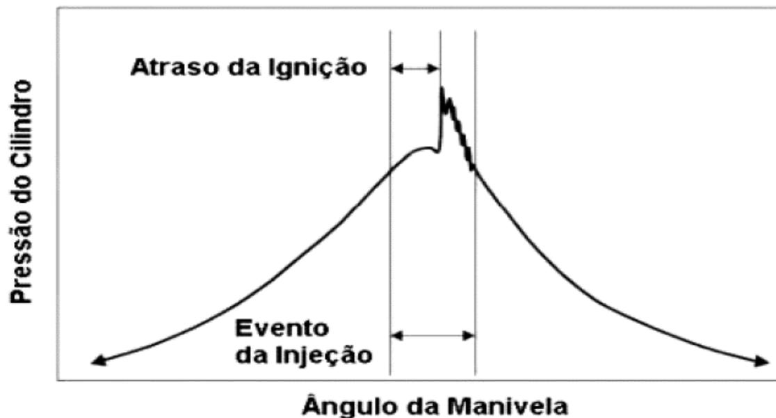
**Figura 3:** Pressão no cilindro em função ao movimento de pistão (Contreras, 2013)
