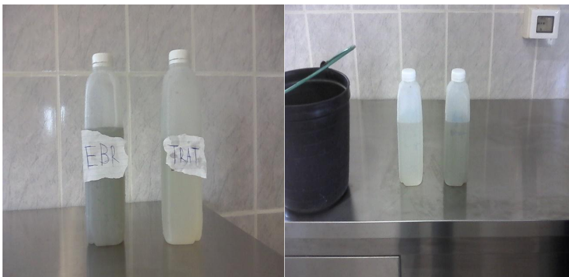
Figura nº10: Amostras de Esgoto Bruto e Tratado
