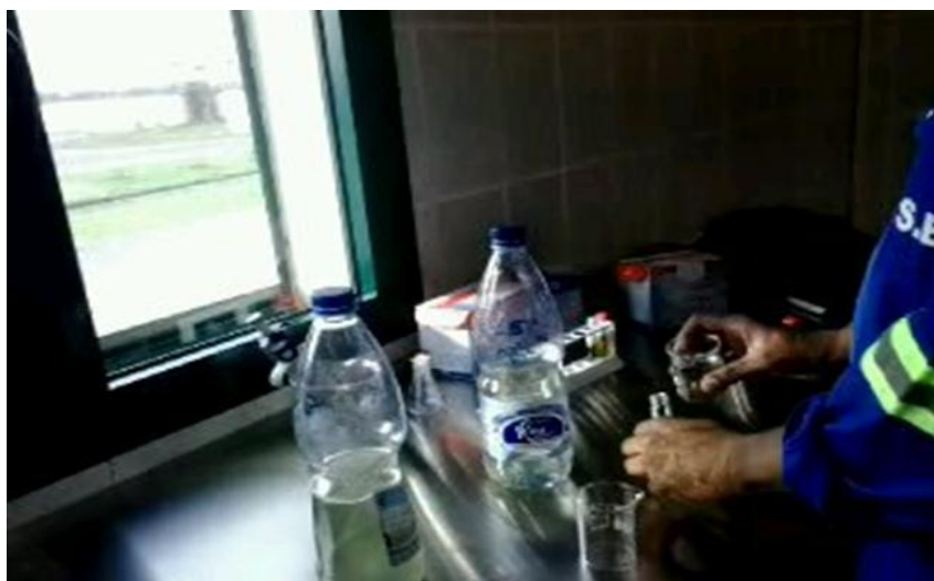
Figura nº14: Fase de Mistura das Amostras com os Reagentes para a Determinação de DQO
