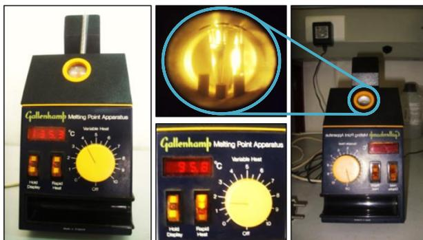
*Figura 24: Aparelho de determinação do ponto de fusão*
