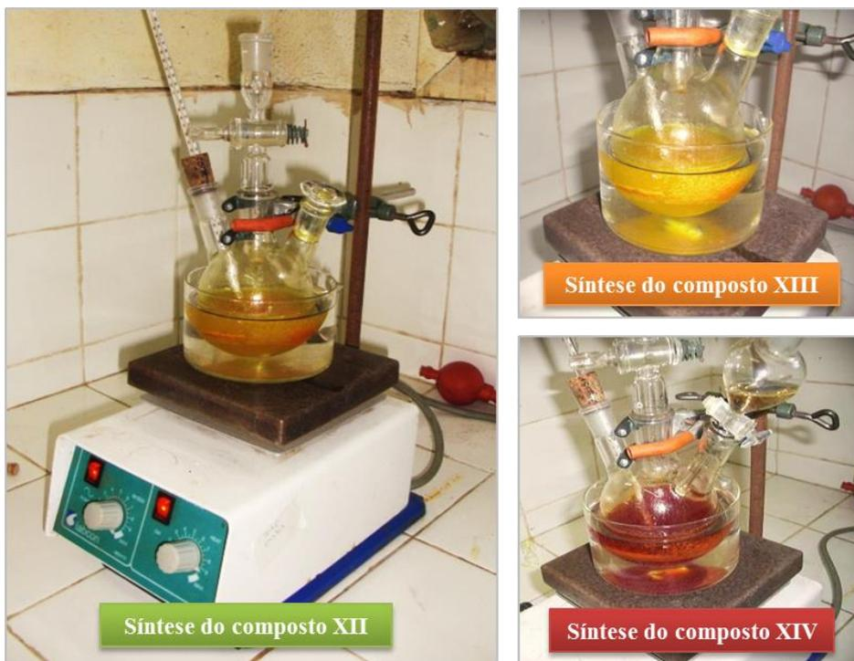
**Figura 20:** Ilustração dos reactores das sínteses
