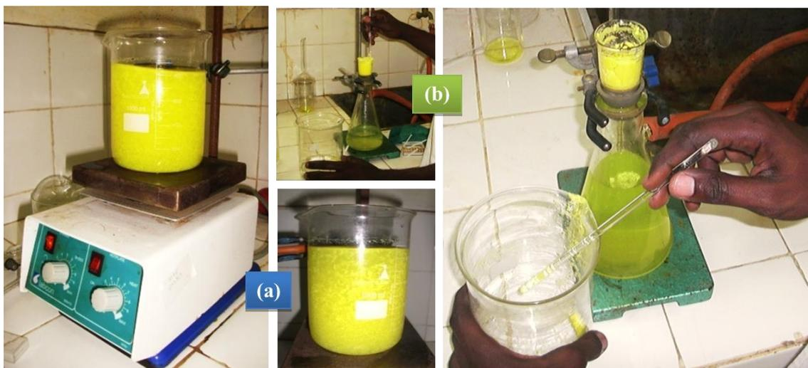
**Figura 21:** Ilustração do processo pós adição de HCl (a) e lavagem do produto sintetizado (b)
