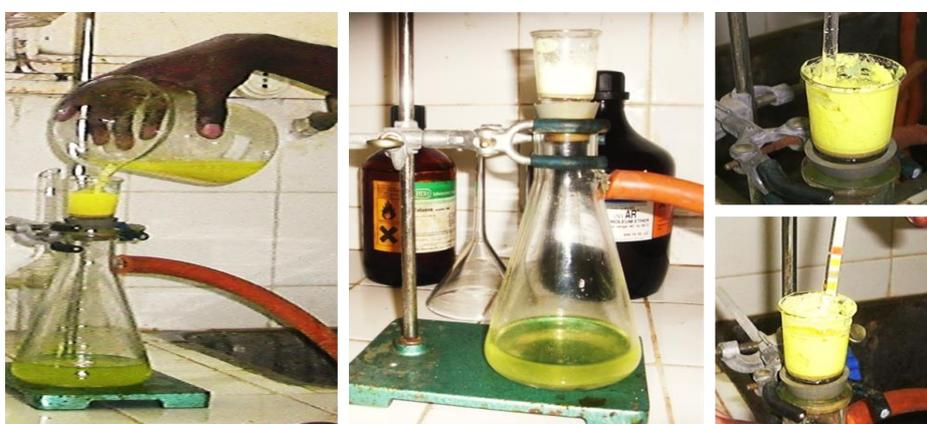
*Figura 22: Processo de filtração por sucção dos produtos sintetizados*
