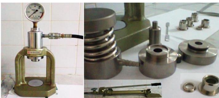
*Figura 27: Acessórios usados na preparação e leitura nas amostras no espectrofotómetro IV*
