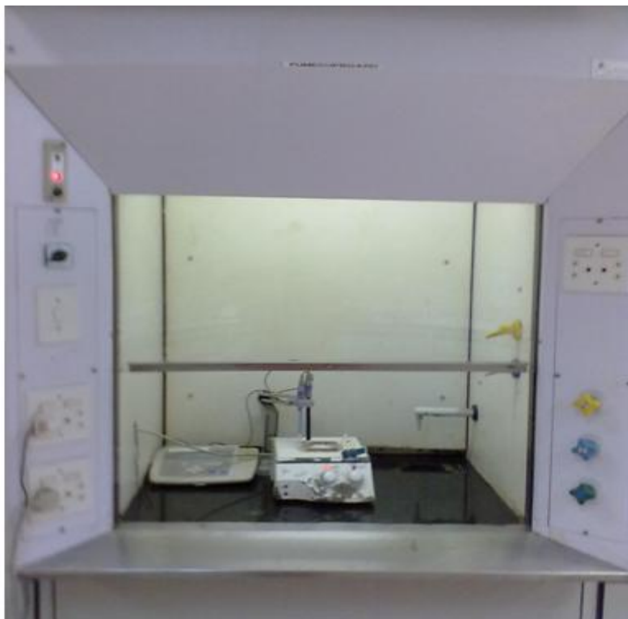
Figura 8: Foto que ilustra o tipo de equipamento utilizado para análise potenciométrica: Potenciómetro, ESI, eléctrodo de referência de Ag/AgCl (fonte: Mozal)
