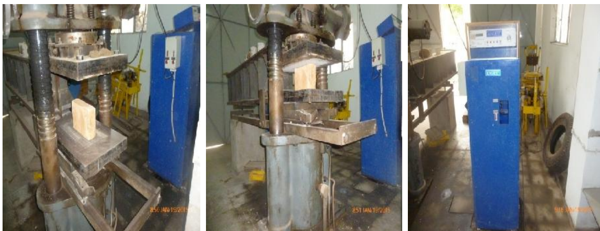
Figura 17: Procedimentos de ensaio da resistência à compressão.
