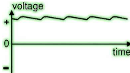
Figura 19: Onda pulsante após ser filtrada
