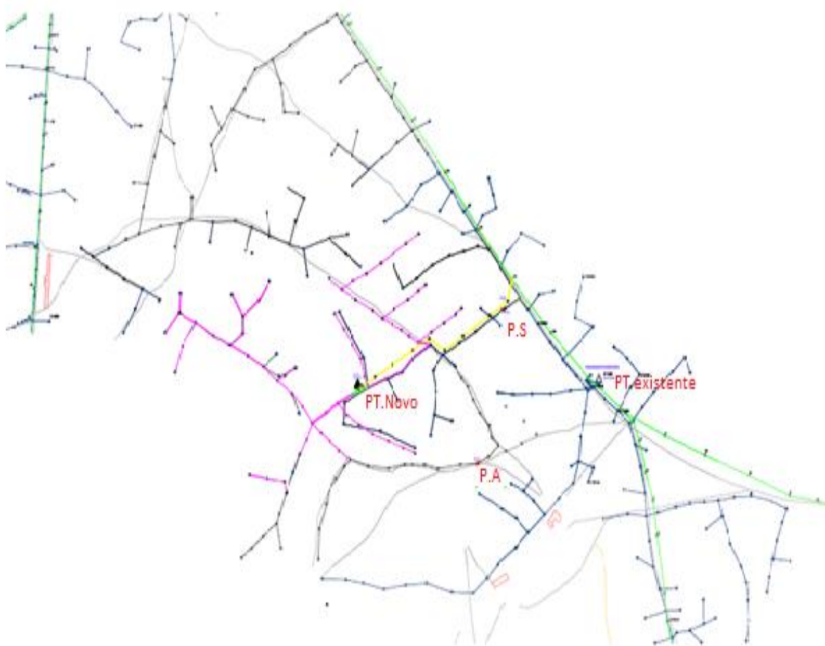
Figura 2: Rede de distribuição de energia eléctrica melhorada
