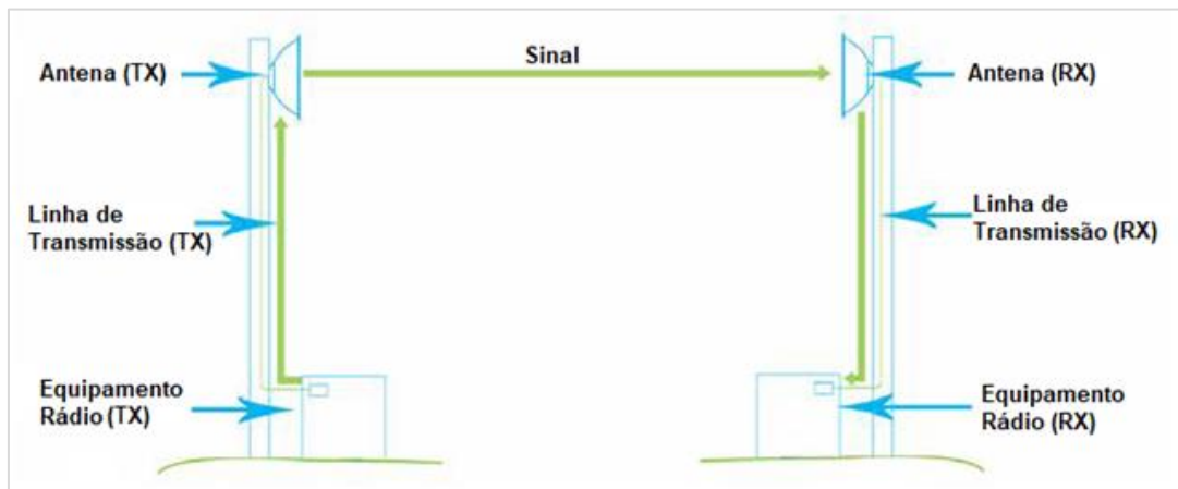
Figura 3.1. Componentes de um link de microondas (COMMSCOPE, 2017).
