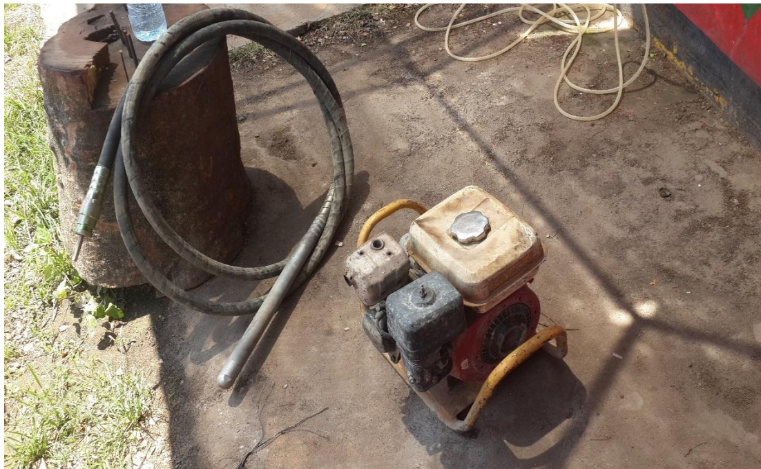
Fotografia 20: Vibrador (Maquina de vibrar betão) (Fonte: Autor)
