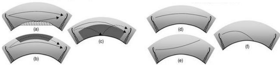
Figura 3: Trajetórias de ondas electromagnéticas desvanecidas, (14).
