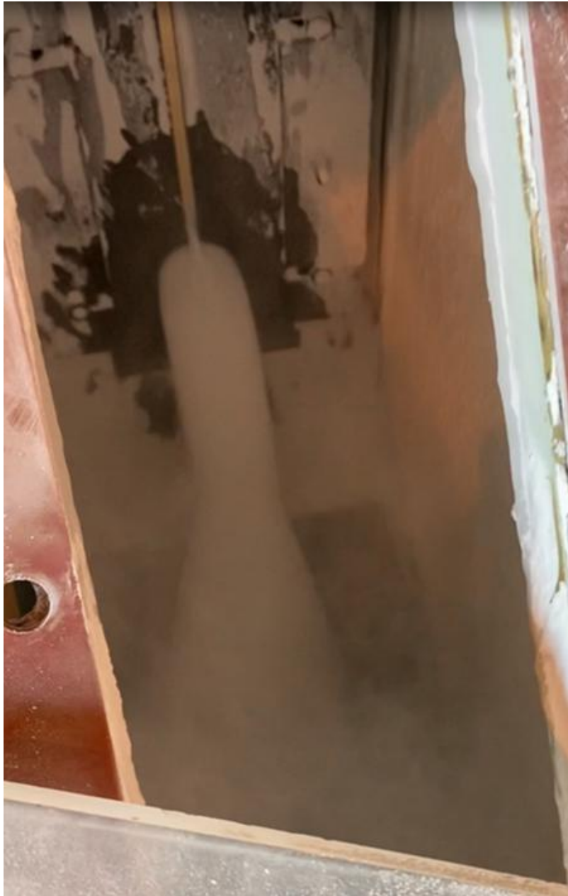
Figura A6-3: Caixa de alimentação de alumina fresca com duplicação do caudal.
