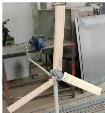
Figura 4.5 – Construção do rotor
