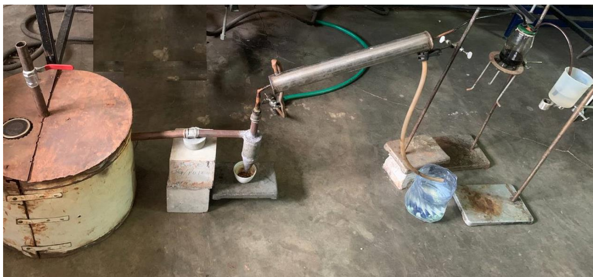
Figura 3.16 - Unidade pirolítica com reactor de leito fixo.
