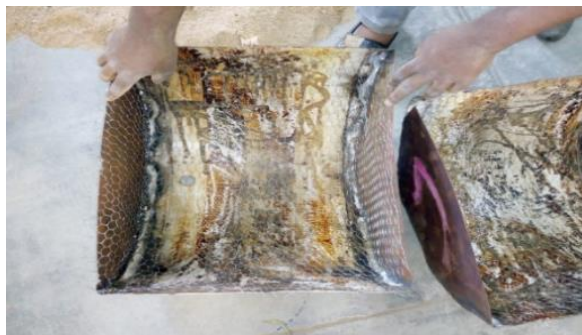
Figura 3.12 - Moldes do isolamento térmico.
