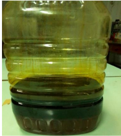
Figura 4.4 - Bio-óleo da mistura do bagaço da cana-de-açúcar e a casca da castanha de caju sem catálise.
