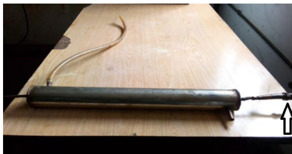
Figura 3.11 - O condensador usado após montagem da união metálica.
