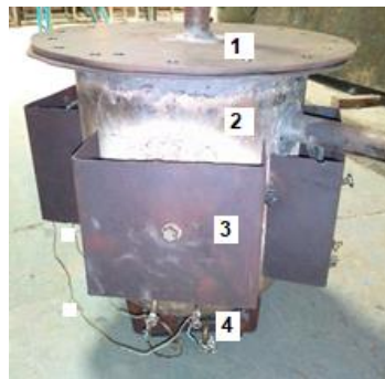
Figura 3.7 - Reactor com as 5 resistências eléctricas.
