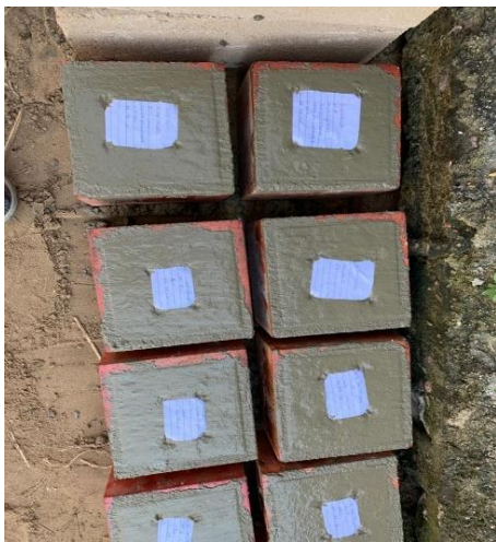
Figura 26– Provetes cúbicos para ensaio de compressão no laboratório
