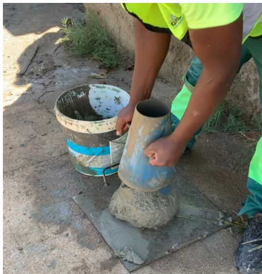
Figura 25 – Realização do ensaio de abaixamento do cone de Abrams
