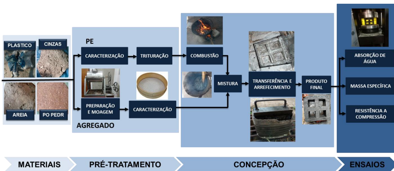
Figura 25: Fluxograma de processo de produção dos tijolos. Fonte: Autor.
