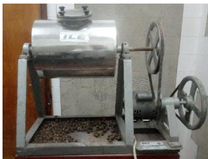
Figura 19: Equipamento usado para moer as cinzas – Moinho de Bolas. Fonte: Autor.
