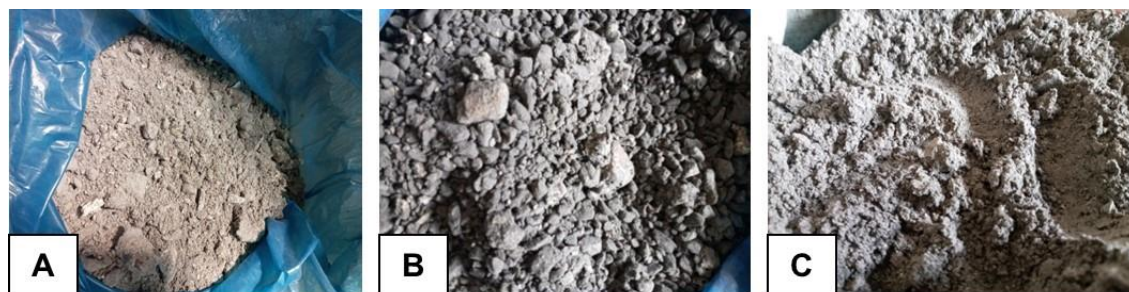
Figura 20: A - cinzas pesadas antes do processo da moagem, B - cinzas mais grosseiras contendo algumas impurezas (resíduo) e C - cinzas já prontas para o uso (que passaram da grelha da peneira). Fonte: Autor.
