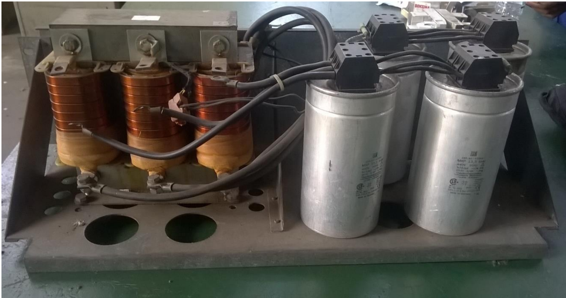
Figura 12: Modulo compacto de capacitores e bobinas anti-surto (Fonte: O Autor)
