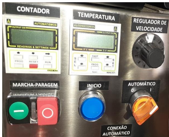
Figura 27: Ajuste da temperatura das mandíbulas
