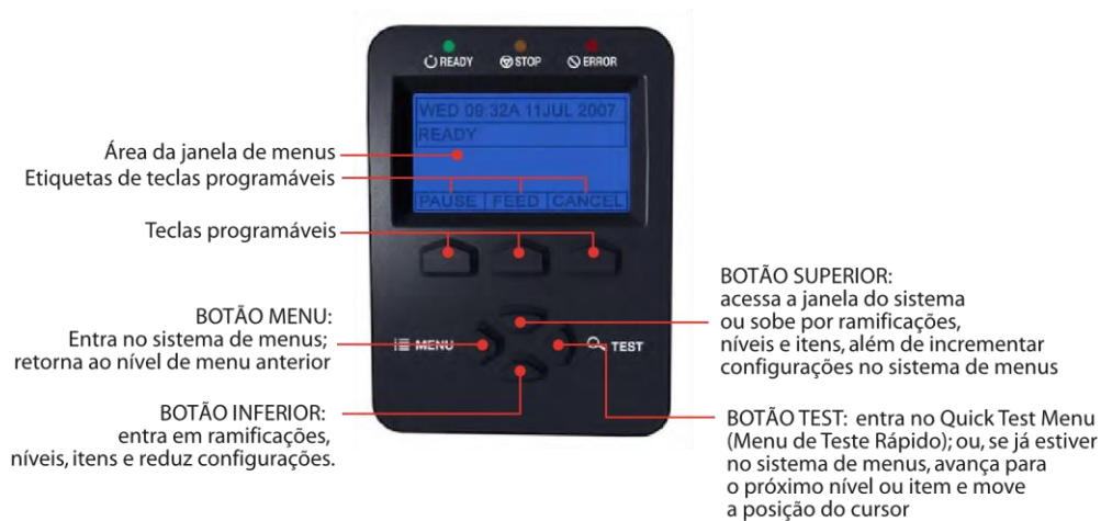
Figura 10: Funções específicas do painel de controle da impressora Datamax M-Class Mark II
