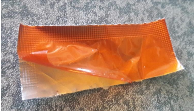
Figura 26: Empacotamento com erro de corte e selagem
