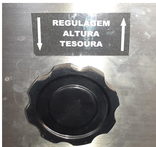
Figura 28: Ajuste da altura da tesoura
