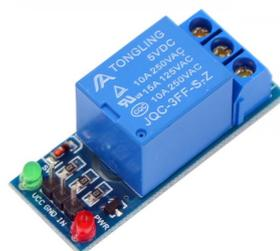
Figura 3.3: Módulo Relé de um canal. Fonte: <https://alexnlid.com/>
