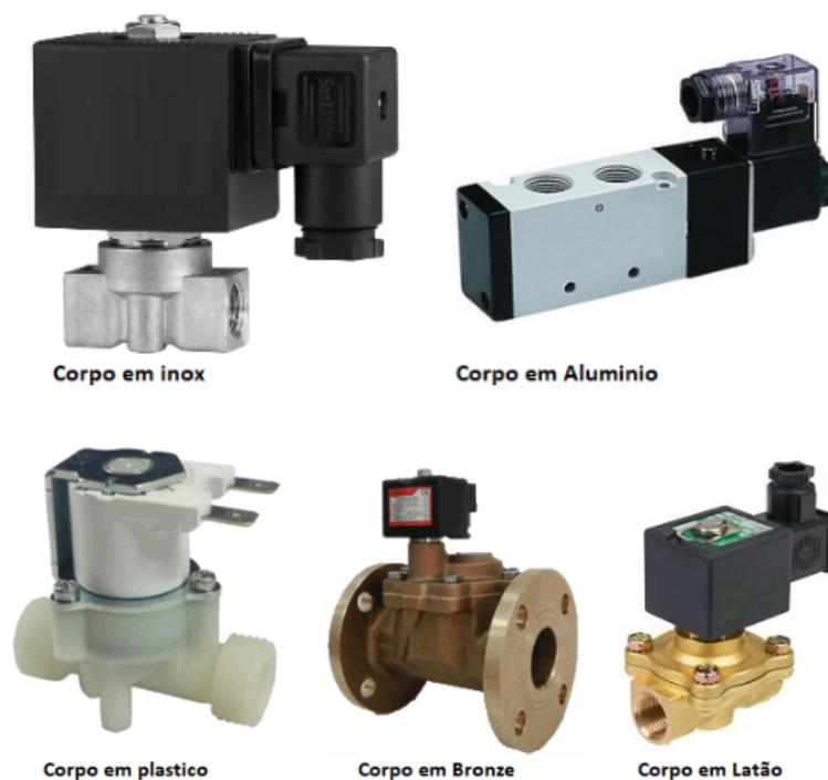
Figura 2.27: Tipos de material para as válvulas solenoides. Fonte: <https://www.jefferson.ind.br/conteudo/valvula-solenoide.html>
