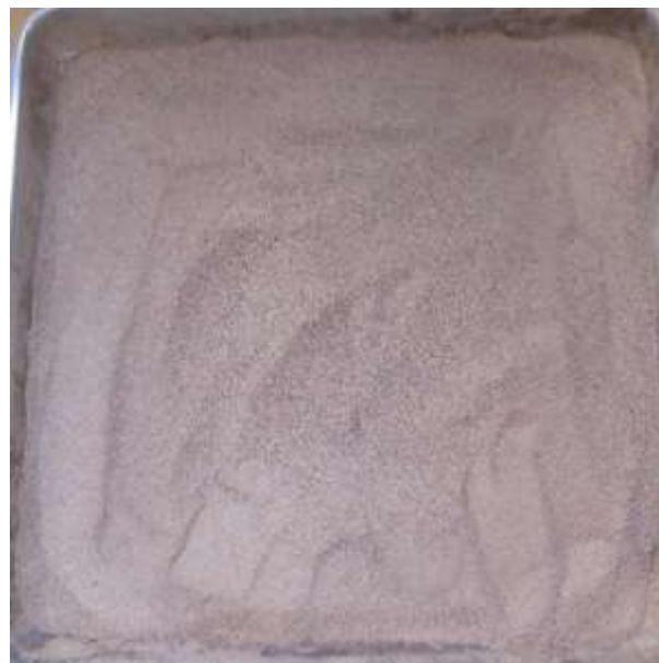
Figura 5. Amostra de Casca de Mandioca após a moagem
