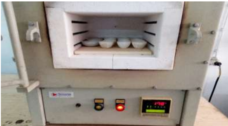
Figura 7. Amostras antes da Calcinação
