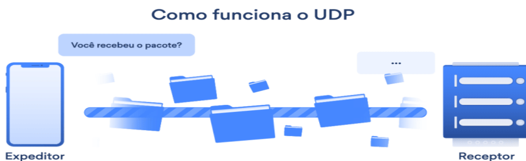
Figura 8 - Funcionamento do protocolo UDP
