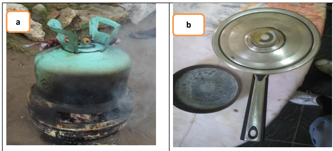
Figura 7: Reactor de pirólise a)Projectado. b)Equipamento alternativo ao projectado – Painela de pressão
