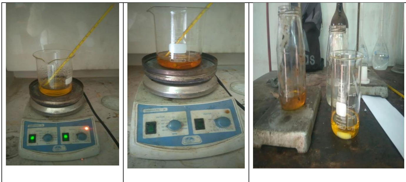
Figura 15: Lavagem do diesel sintético. a) Secagem a 105. b) Arrefecimento. c) comparação
