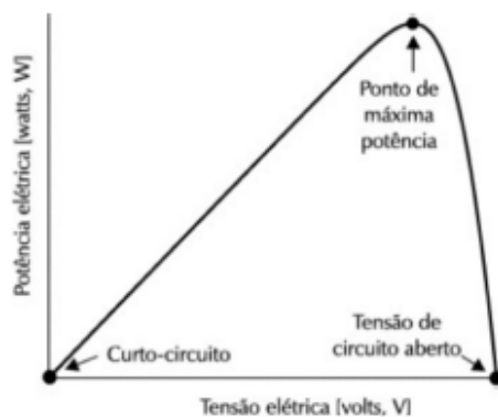
Figura 9 - Curva característica da potência e tensão do módulo fotovoltaico. [4]
