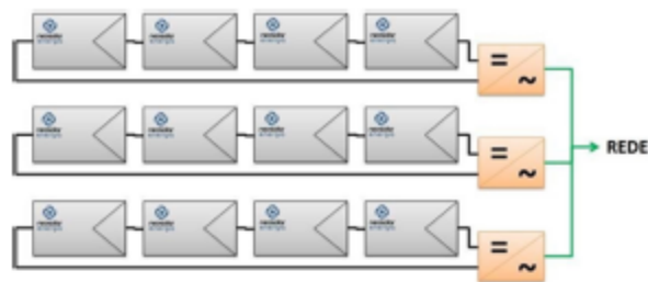
Figura 15 - Esquema de ligação de módulos a um Inversor em fileira.[12]
