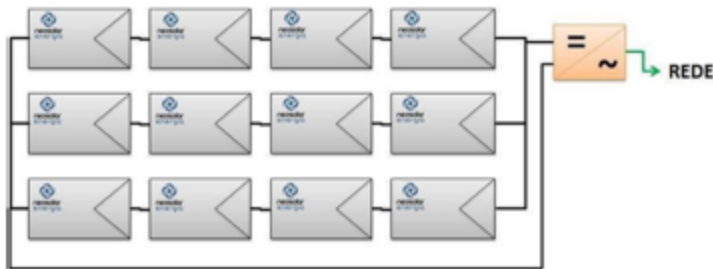
Figura 14 - Esquema de ligação de módulos a um Inversor Central.[12]
