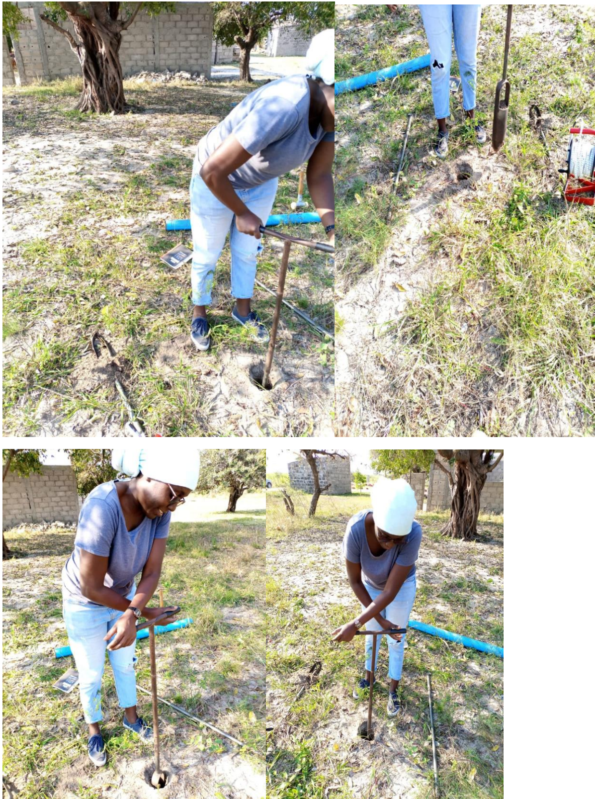
Figura C-3.1: perfuração do poço para a realização do slugtests
