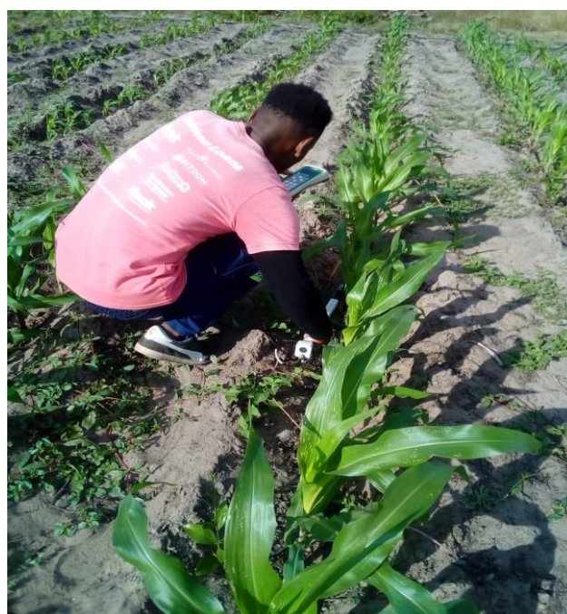
Figuras I e II: Medição de índice de área foliar por LAI 2200C Canopy analyzer
