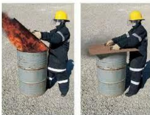
Figura 3. Extinção por abafamento Fonte: (Rocha, 2018)
