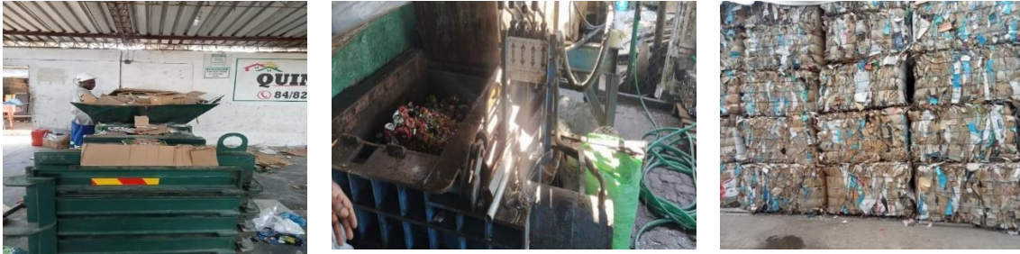
Figura 6. Processo de compactação dos resíduos sólidos
