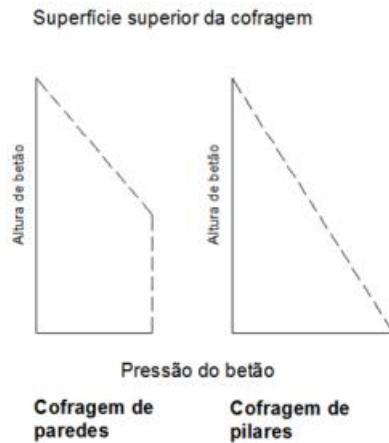
Figura 7. Diferença entre pressões na cofragem de paredes e na cofragem de pilares (fonte: ACI 2001) [1]
