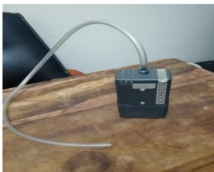
**Figura 4:** Bomba de sucção conectada ao tubo cristal
