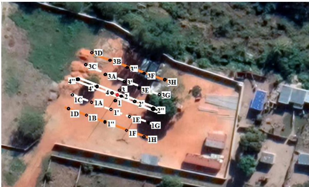
Figura 25: Demarcação dos Pontos de Medição (Simulação da estrada com as distâncias)
