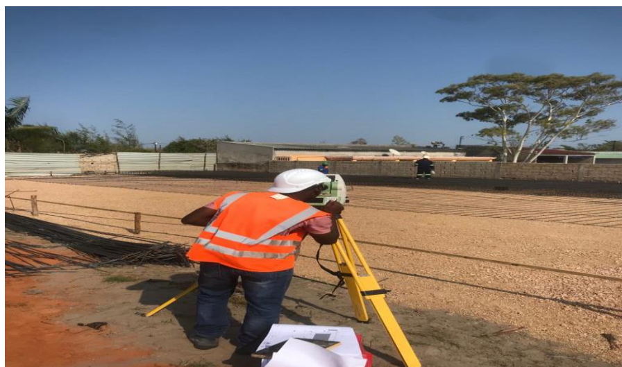
Figura: 7 Tec.Topógrafo usando estação total(fonte- autor)
