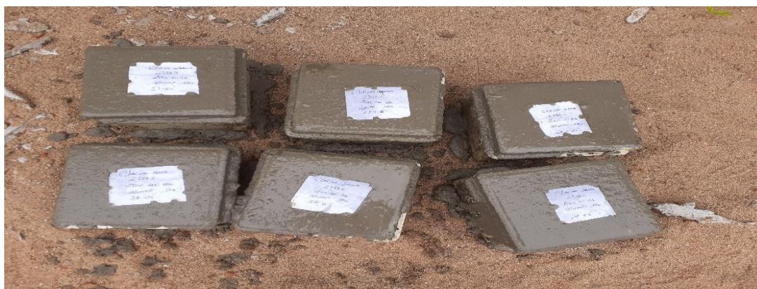
Figura: 42 Preenchimento dos cubos para o ensaio(fonte-autor)
