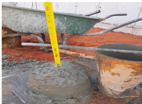
Figura: 41 Leitura do cone de Abrams(fonte-autor)
