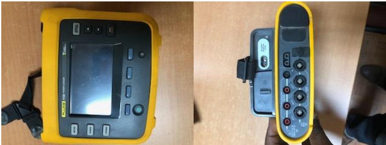
Figura Anexo 4.4 Analisador de instalações de rede de distribuição de energia eléctrica
