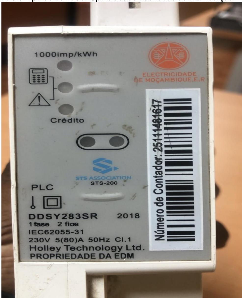
Figura Anexo 5.5 Tipo de contador Splitte usado nas redes de distribuição
