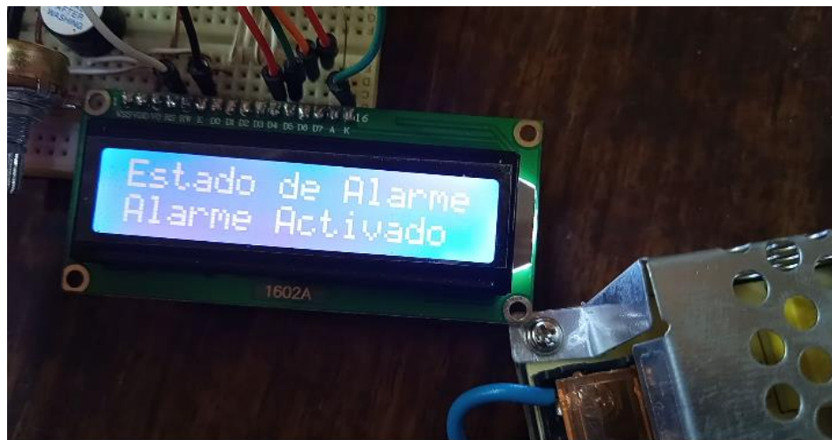
Figura 37 SAI: Situação do Alarme 50
