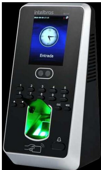
Figura 14: Leitor de sistema de Controlo de Acesso. [10]
