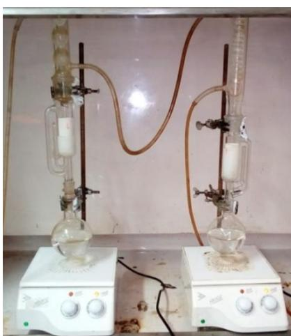
Figura 12: Sistema *Soxhlet* usado para a extracção de lípidos.
