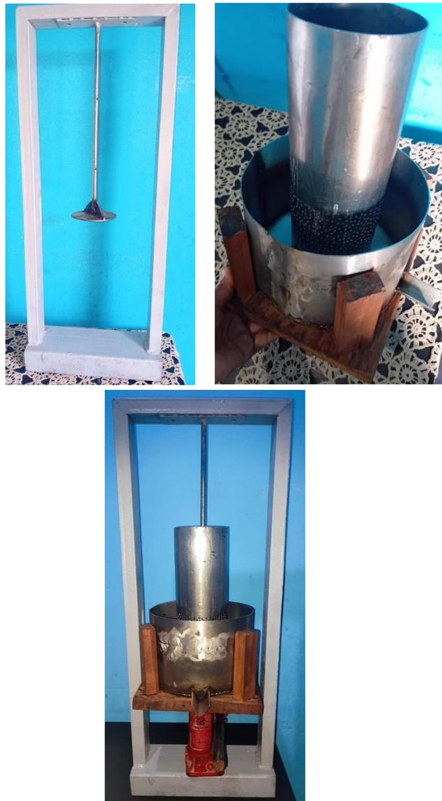
Figura A1-1: Prensa hidráulica usada para a extracção do leite de coco.
