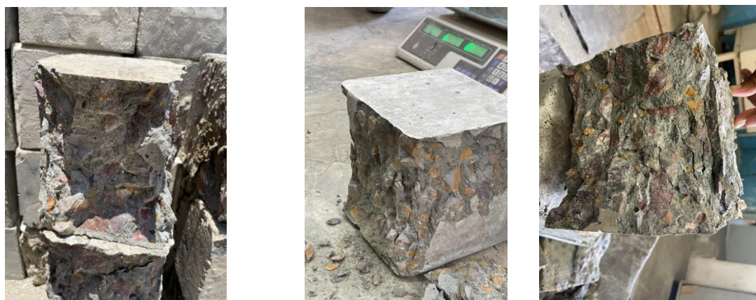
Figura 25: Roturas satisfatórias dos provetes ensaiados
