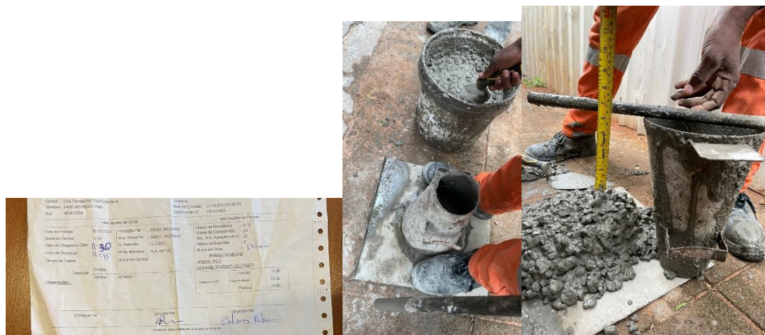
Figura 22: Guia de Remessa do 1º camião, realização do ensaio de abaixamento e apresentação do abaixamento encontrado.
