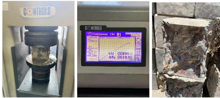
Figura 21: Realização do ensaio; Leitura dos Resultados no LEM,IP e identificação do tipo de rotura.
