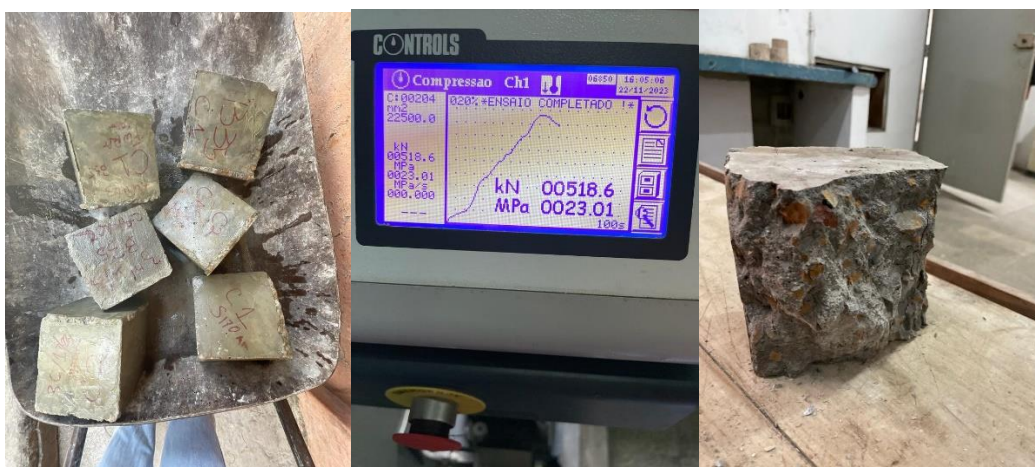
Figura 23: Remoção dos cubos do tanque de cura e Transporte; Leitura dos Resultados e identificação do tipo de rotura.
