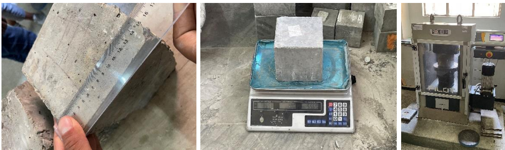
Figura 20: Obtenção das medidas da amostra (área); Pesagem da amostra; Realização do ensaio de compressão
