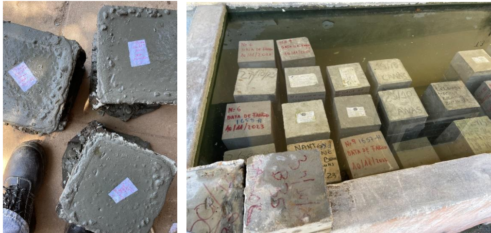
Figura 19: Identificação dos cubos após a betonagem e cura dos provetes de betão em tanque.
