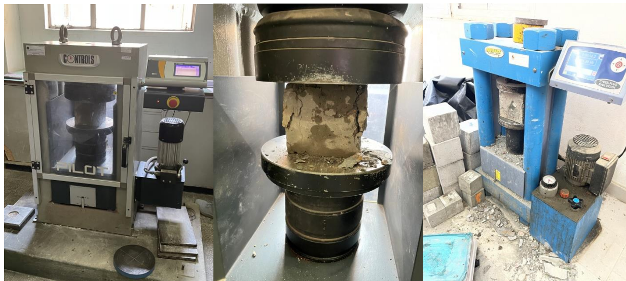
Figura 4: Máquina de Ensaio de compressão, à esquerda pertencente ao LEM e à direita, ao laboratório da central de betão.
