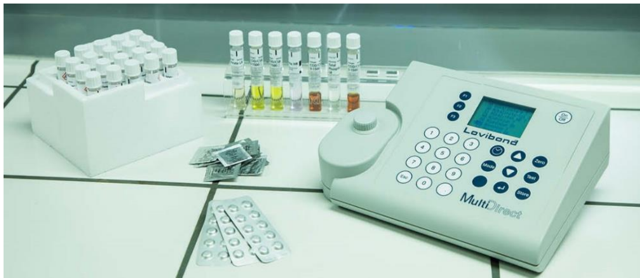
Figura 12. Espectrofotómetro Lovibond MultiDirect XD 7500 para análises de AT, DT, cloro, cloretos e sulfatos.
