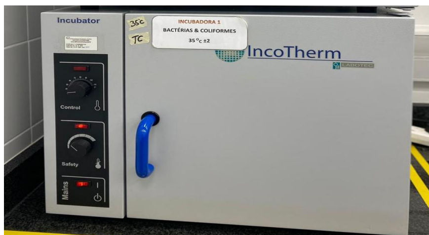
Figura 13. Incubadora IncoTherm da LABOTEC utilizada durante a determinação de microrganismos.
