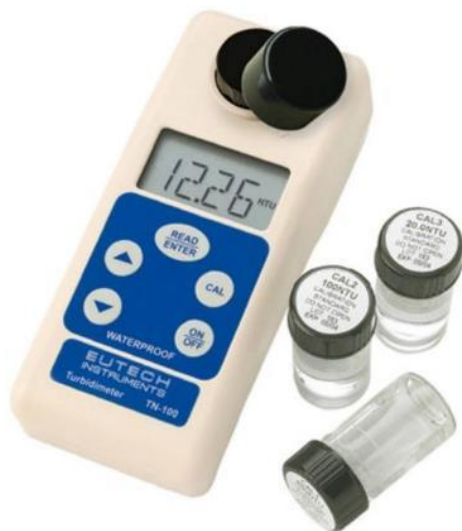
Figura 10. Turbidímetro EUTECH Instruments TN-100 utilizado para determinar a turvação.
