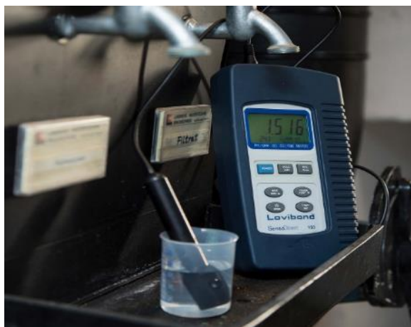
Figura 11. Condutímetro Lovibond SensoDirect 150 utilizado para determinação de CE e TDS
