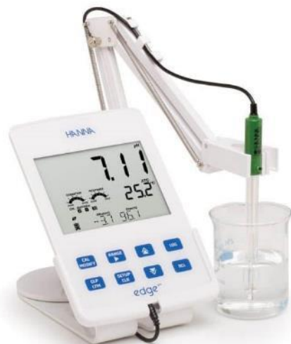
Figura 9. pHmetro HANNA Edge utilizado na determinação de pH das amostras.
