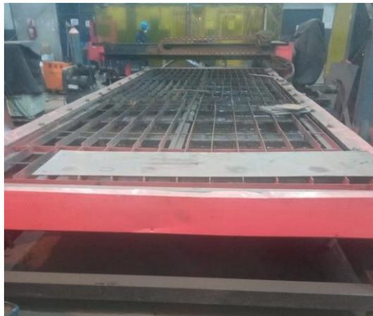
Figura 4 imagem de maquina de corte a plasma
