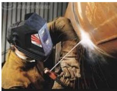
Figura 9 soldadura por eléctrodos revestido
