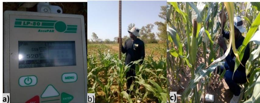
**Figura 3:** Ilustração do ceptómetro (a) e medição da altura das plantas (b) e do índice da área foliar (c).
