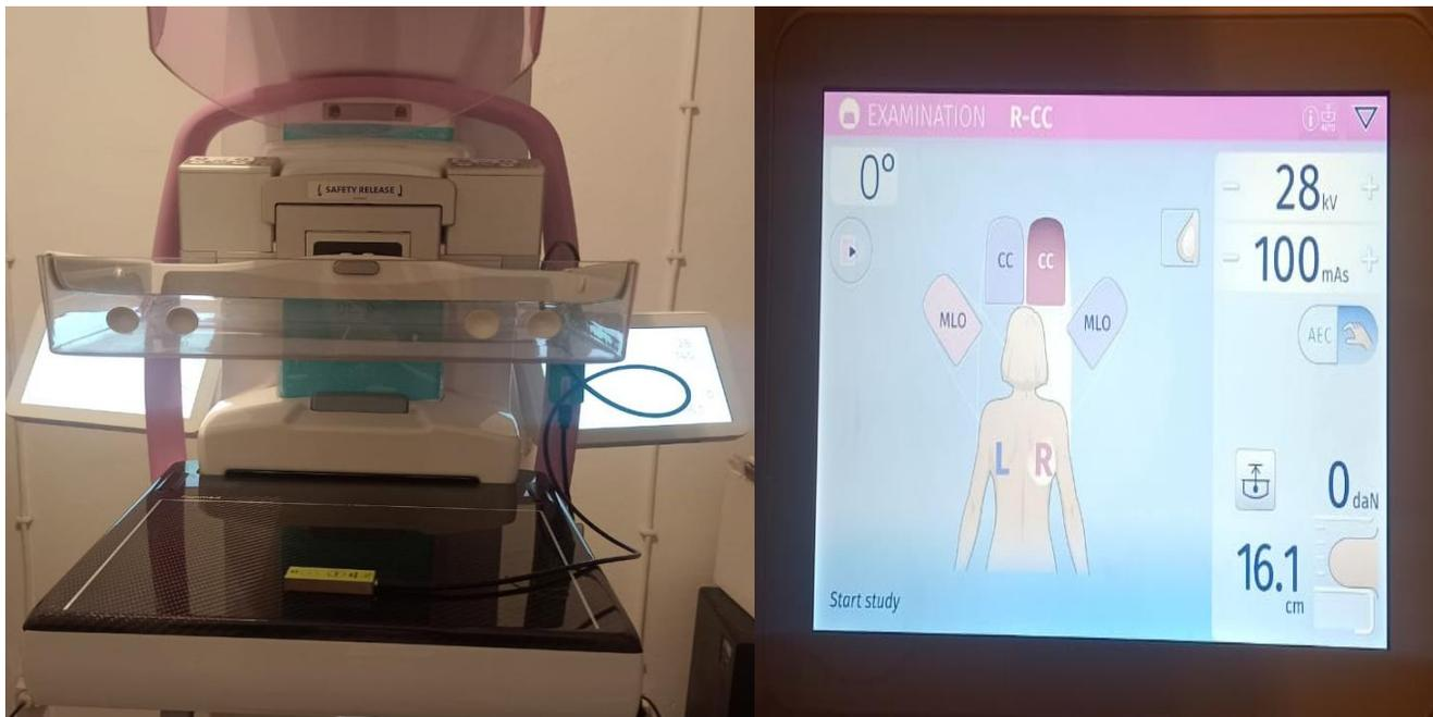
Figura 4. 1: Montagem experimental do teste de exactidão e reprodutibilidade do tempo de exposição
