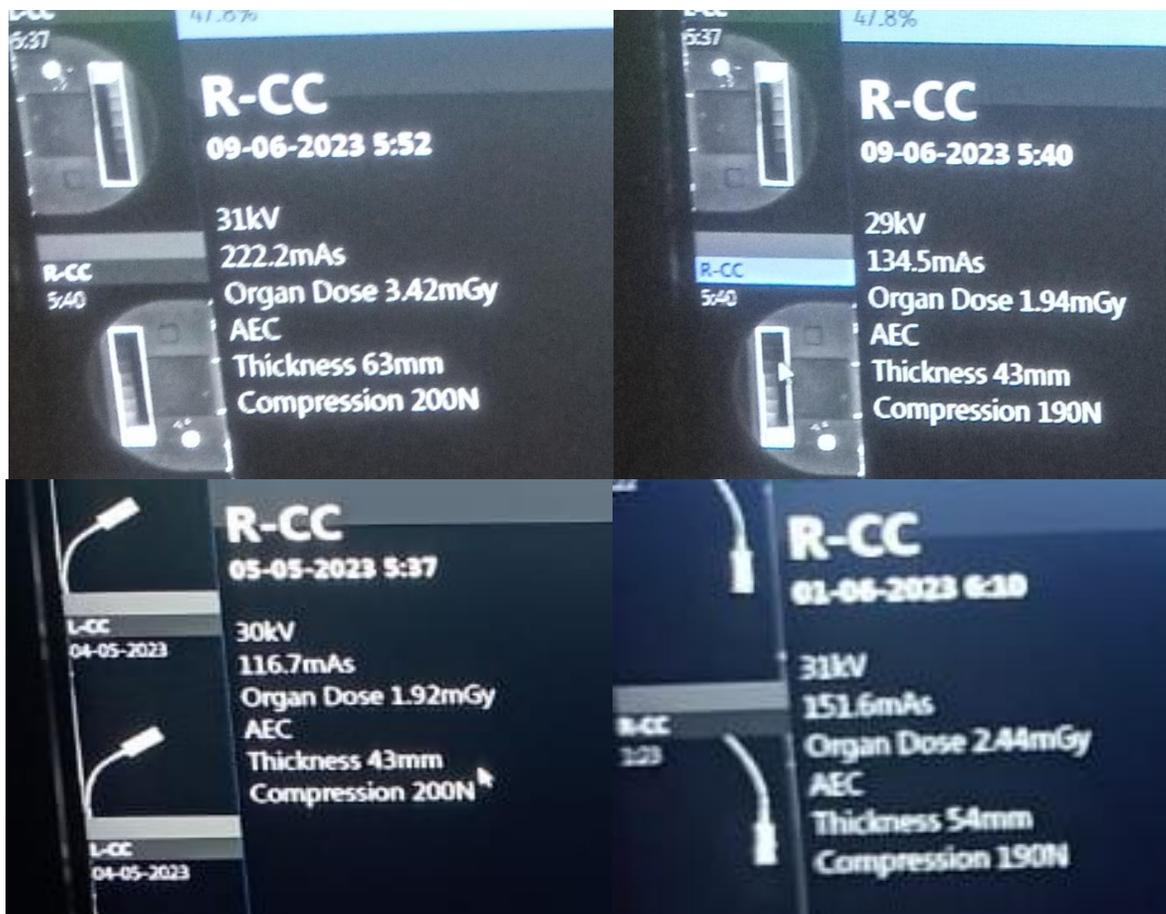
Figura 4. 3: Medida da Força de compressão a partir do monitor do mamografo do HCM
