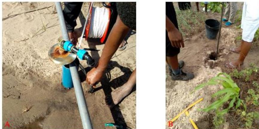
**Figura 37:** A.Sensor de nível; B. Trado manual;
