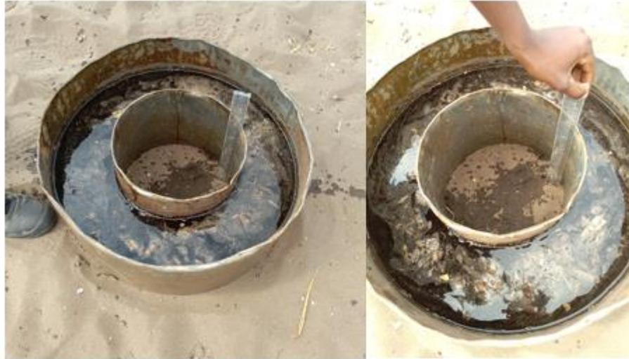
**Figura 36:** Método de anéis concêntricos usados no teste da capacidade de infiltração. Os dados foram colectados manualmente, de várias formas como por um medidor de nível com sensor eléctrico e alarme (Figura), e em forma de trado manual (Figura).
