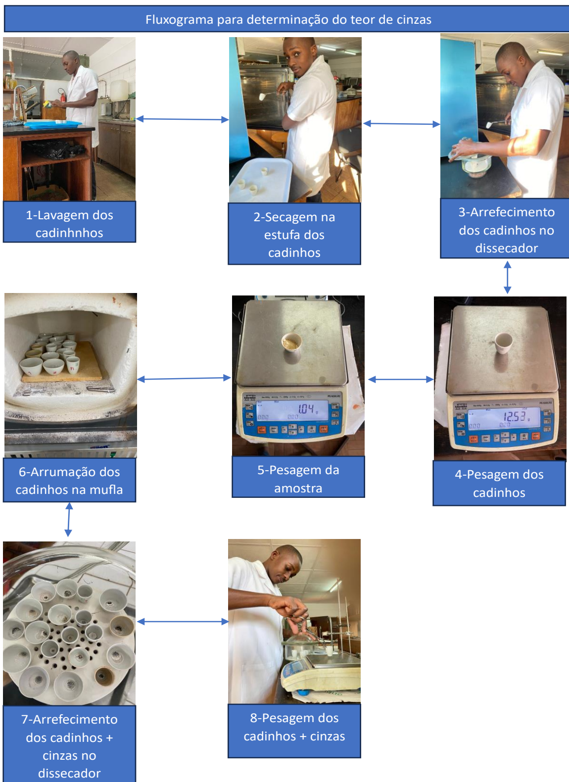
Figura 6: Fluxograma para determinação do teor de cinzas.
