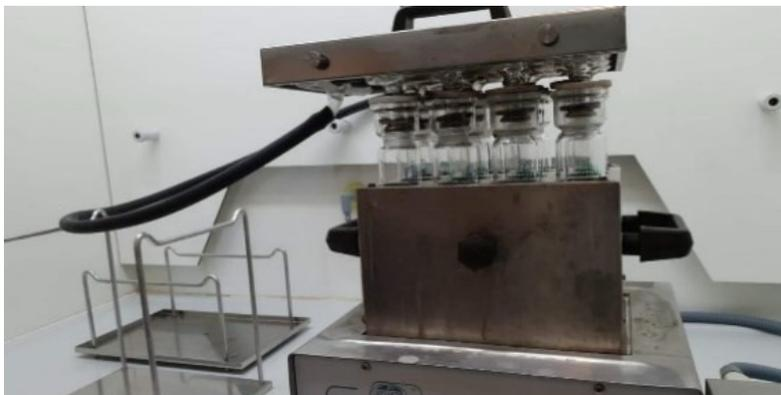
Figura 9: Digestor de proteínas.
