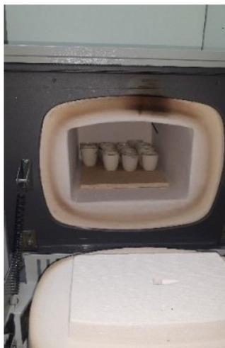
**Figura 10:** Mufla com os cadinhos para o procedimento de incineração.
