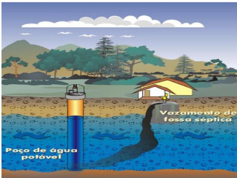
Figura 3. Contaminação de águas subterrâneas por fossas sépticas. Fonte: Salamandane *et al.*, (2021).
