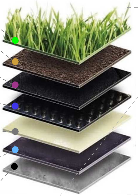
Esquema 59: Representação das Camadas que compõem o sistema de cobertura verde.
