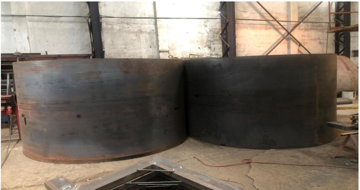
Figura 8 – Produção da virola para um tanque de  $80\text{m}^3$
