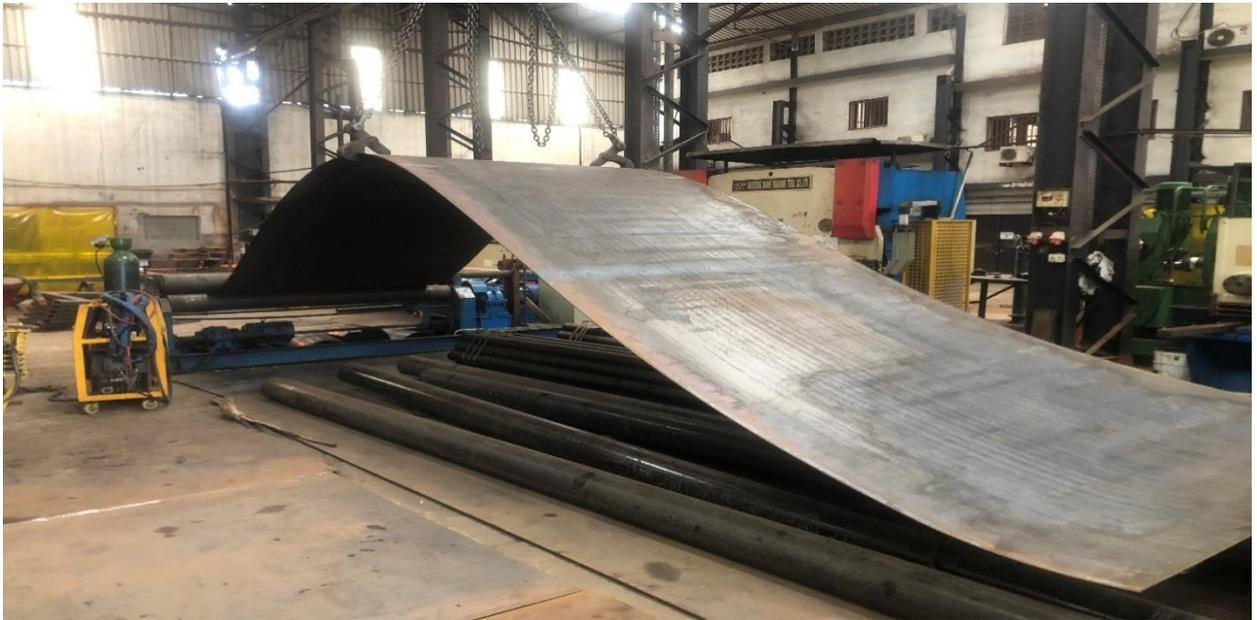
Figura 7 – Processo de calandragem de uma chapa para produção da virola para um tanque de  $80\text{m}^3$
