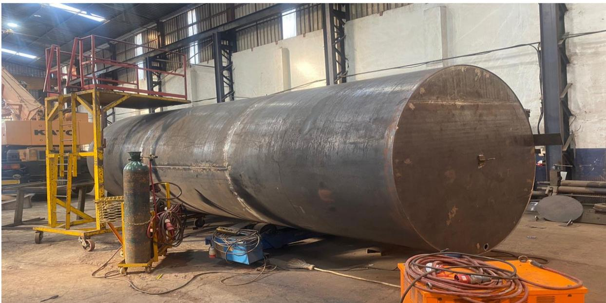
Figura 6 – Produção de um tanque de 25m<sup>3</sup>
