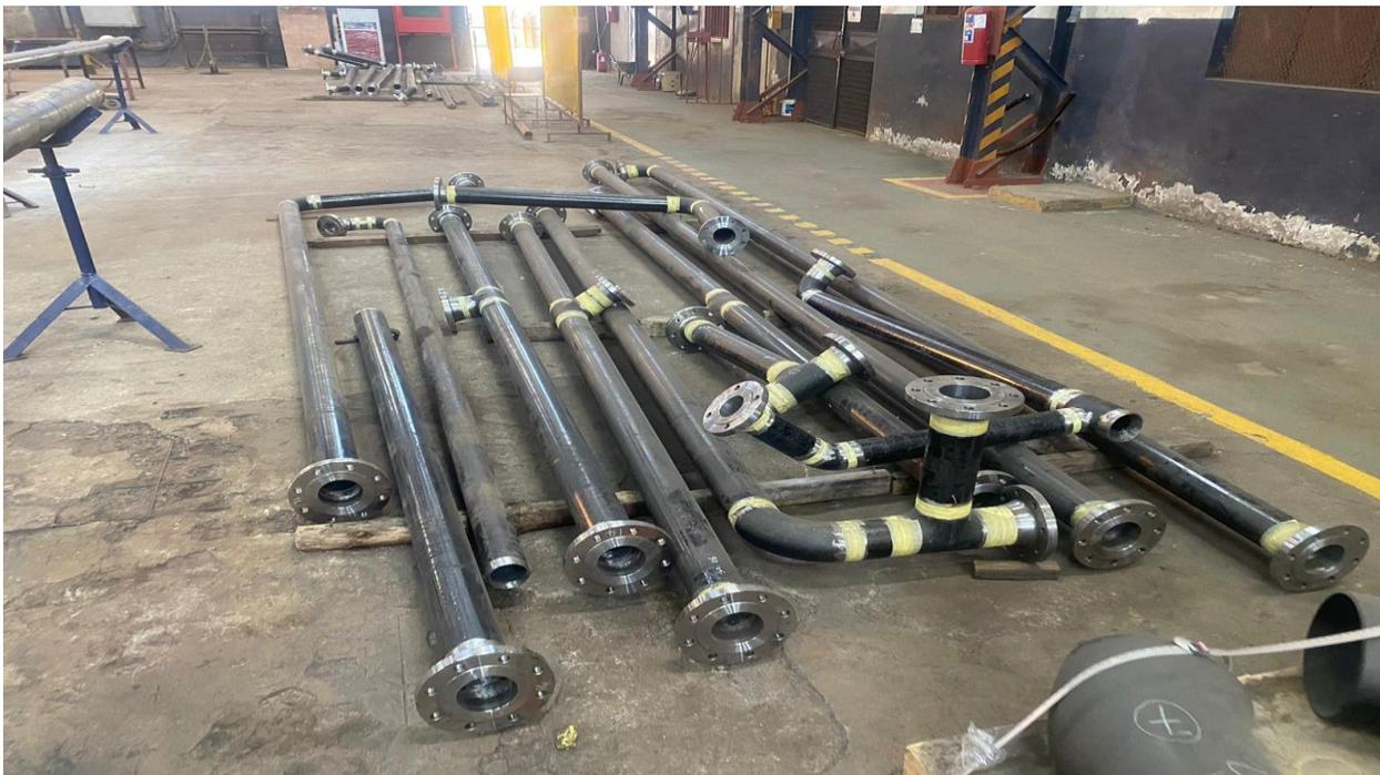
Figura 5 – Produção de condutas para alargamento da bomba de enchimento da GIMTL
