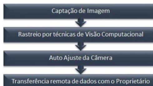
Figura 3: Conceito básico de um sistema inteligente CCTV<sup>9</sup>
