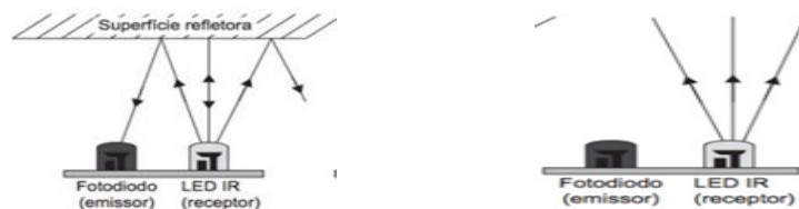
Figura 2.5. - Raios reflectidos e incidentes de um sensor infravermelho.
