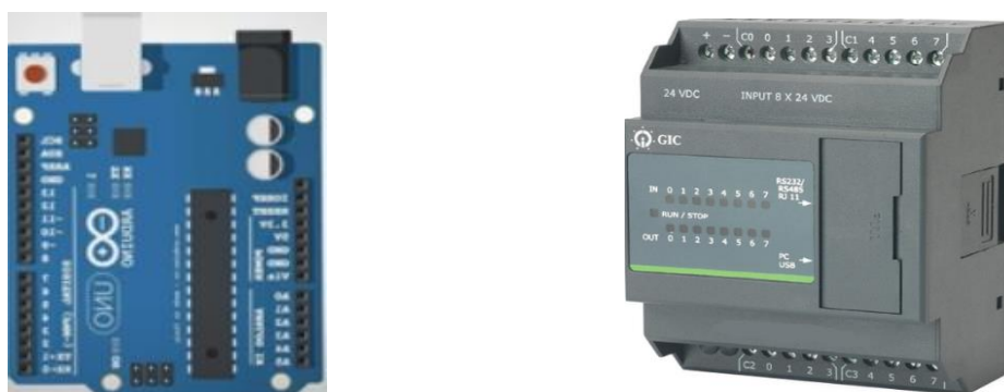
Figura 2.3. - Ilustração de um Arduino vs CLP.
