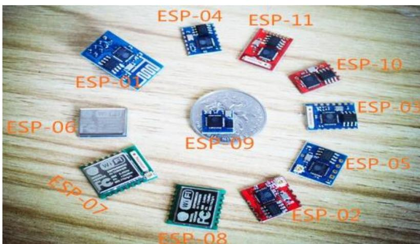
Figura 6: Diversos modelos de esp8266
