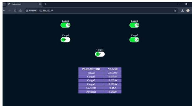
Figura 17: Interface de Controle com Computador
