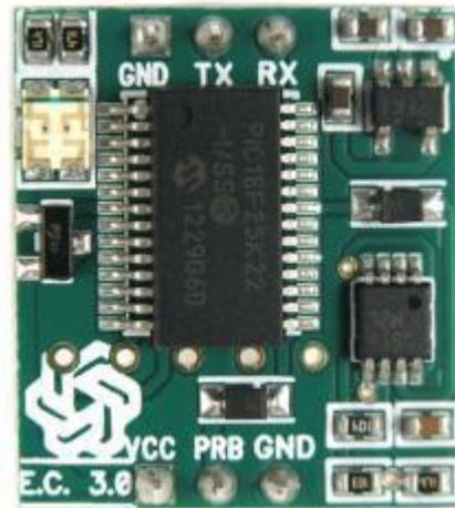
*Fig.2.12. Circuito interno de sensor de condutividade. Fonte: Atlas Cientific(2013)*
