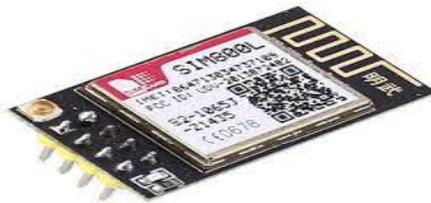
Fig.2.14. modulo gsm (fonte: <https://www.casadarobotica.com/internet-das-coisas/comunicacao/gsm-gps/modulo-gsm-gprs-sim800l>)
