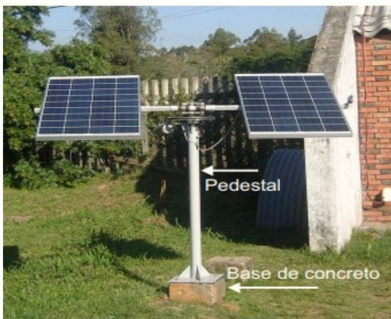
Fig. 12: Seguidor de estrutura pedestal
